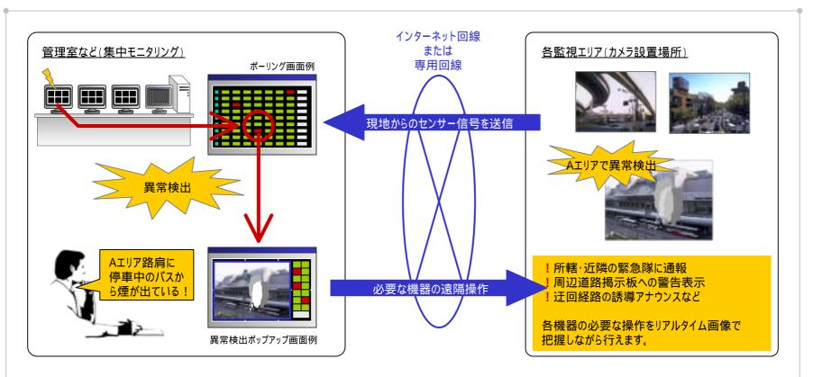
インターネットを介して数百ヶ所を同時に監視する際、各地点(映像)のセンサー信号のみ送信することでネットワークの負荷を下げることができ、 異常検出時に必要箇所への映像接続が瞬時に可能となります。
