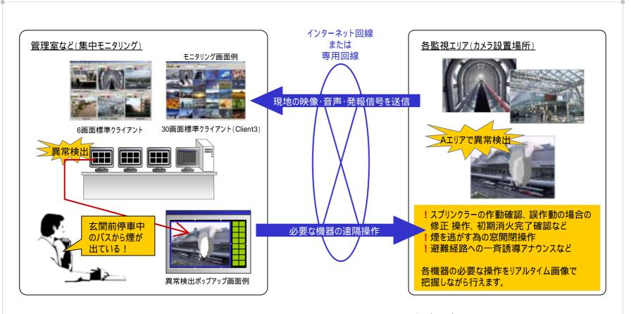
各種センサーを設定した箇所で異常を検出すると、警報を鳴らし、異常個所の映像をポップアップ画面で瞬時に表示します。 異常個所、または全体の様子を映像で確認しながら、必要な機器の操作(初期対応)をそのまま遠隔地から行えます。
